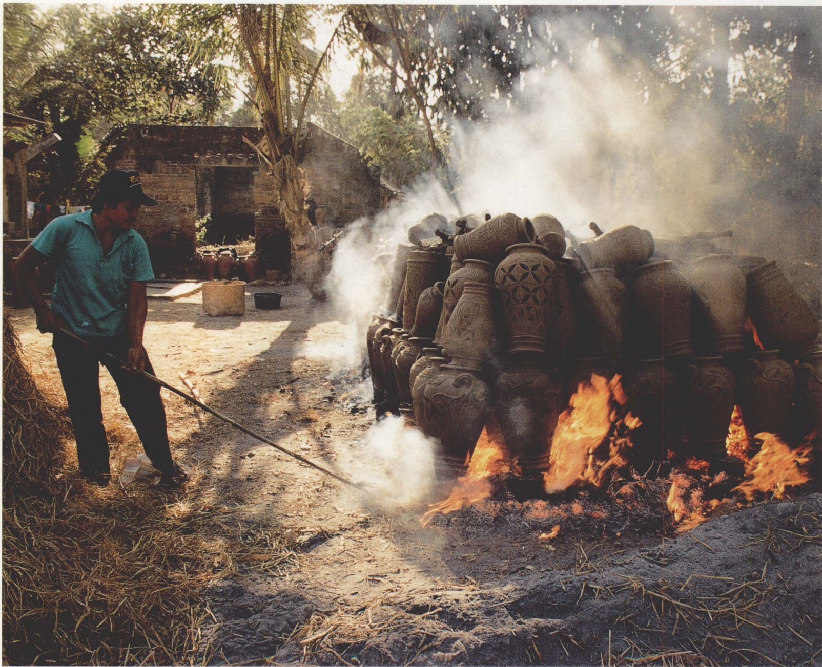
Pembakaran grabah yang masih dilakukan secara tradisional, yaitu membakarnya di halaman rumah dengan dedaunan, sampah dan ranting kayu.
