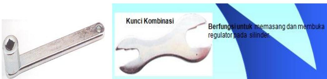
**Gambar2.3.18 Silinder key**
