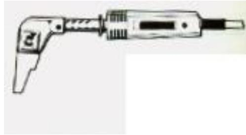
**Gambar 9. 11 Baut-solder untuk pekerjaan industri
