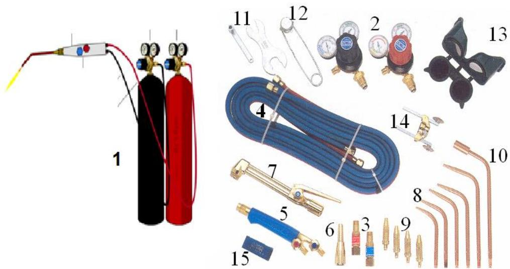
Gambar 3. 11 Peralatan Las Oksi Asetilin
