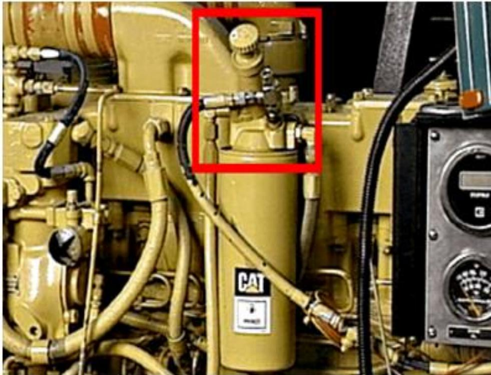
Gambar 3.19. Pada unit Sedimenter dan Filter
