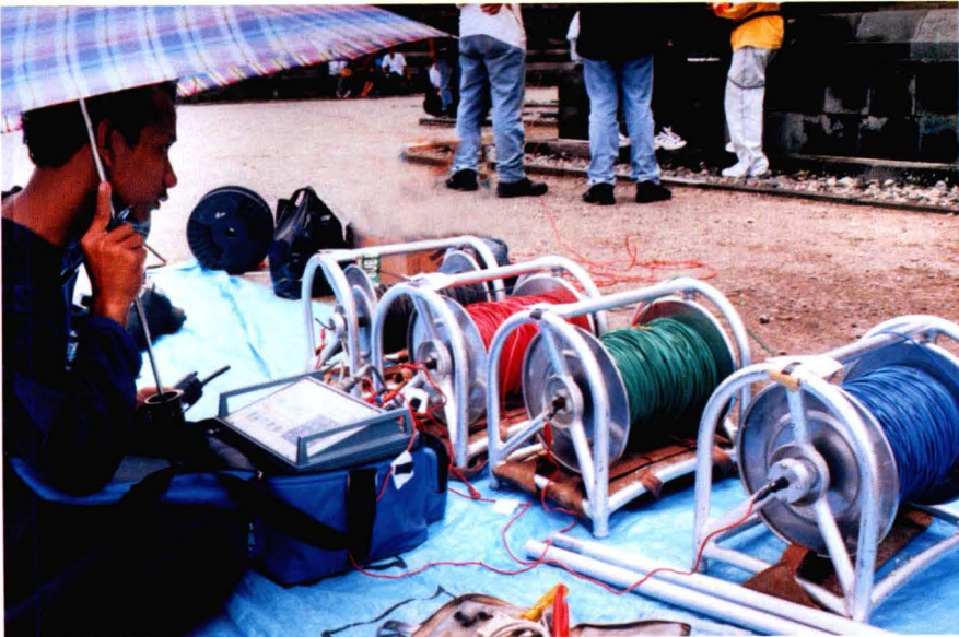
Para peneliti sedang melakukan penelitian dengan alat geo-elektrik pada batuan Candi Siwa Prambanan.
