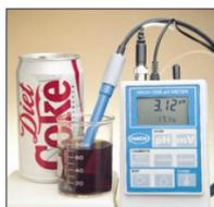
**Gambar 4.2.** pH minuman ringan diukur dengan pH meter modern
