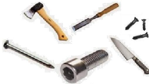
Gambar 37. Peralatan yang memanfaatkan prinsip bidang miring
