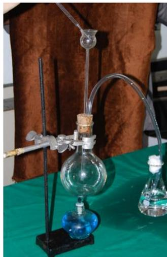
Gambar 3.8 Perangkat pembuatan gas  $\text{CO}_2$
