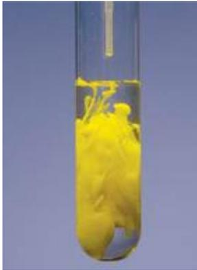
Gambar 3.1 Reaksi KI dengan  $\text{Pb}(\text{NO}_3)_2$
