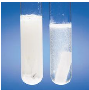
Gambar 3.5 reaksi kalsium karbonat dengan HCl
