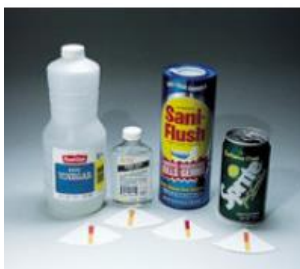
Gambar 4.1. Pengukuran pH bahan kimia di rumah berupa asam lemah dengan indikator universal
