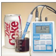
Gambar 4.2. pH minuman ringan diukur dengan pH meter modern
