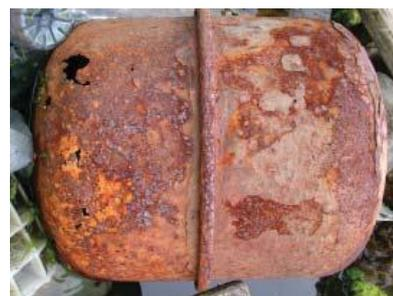
**Gambar 5.2** Proses korosi pada plat besi
