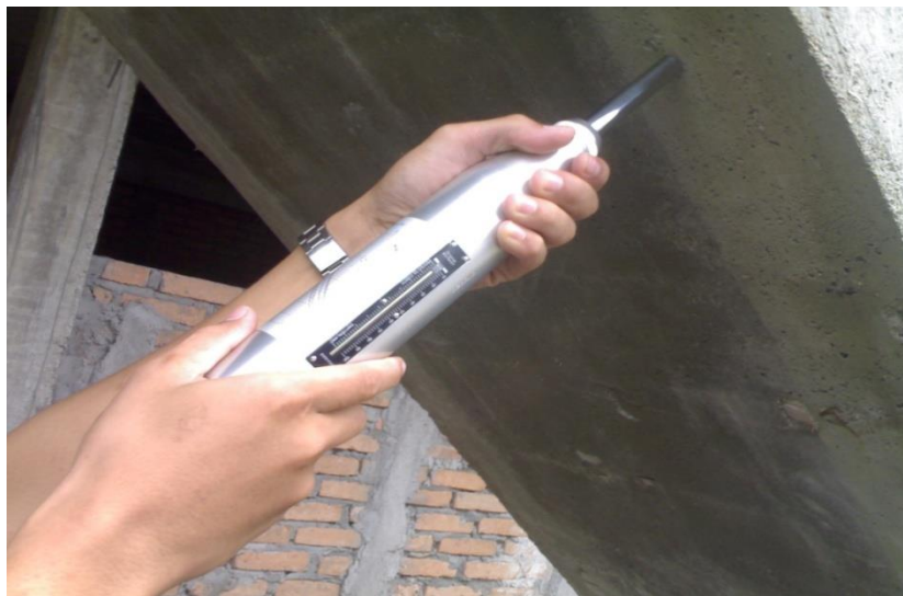
Gambar 25. Posisi Sudut Penggunaan Hammer Test \alpha + 45^\circ
