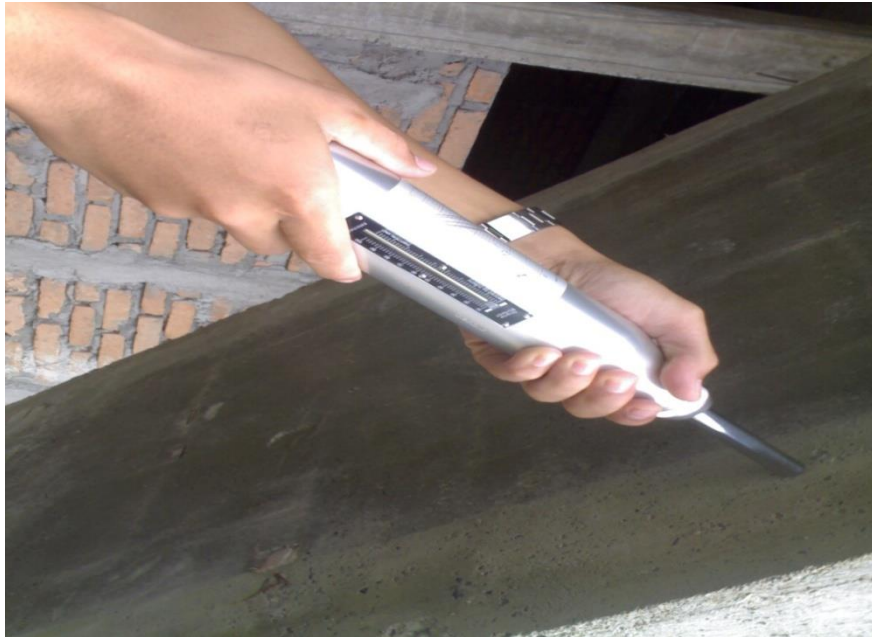
Gambar 26. Posisi Sudut Penggunaan Hammer Test \alpha - 45^\circ
