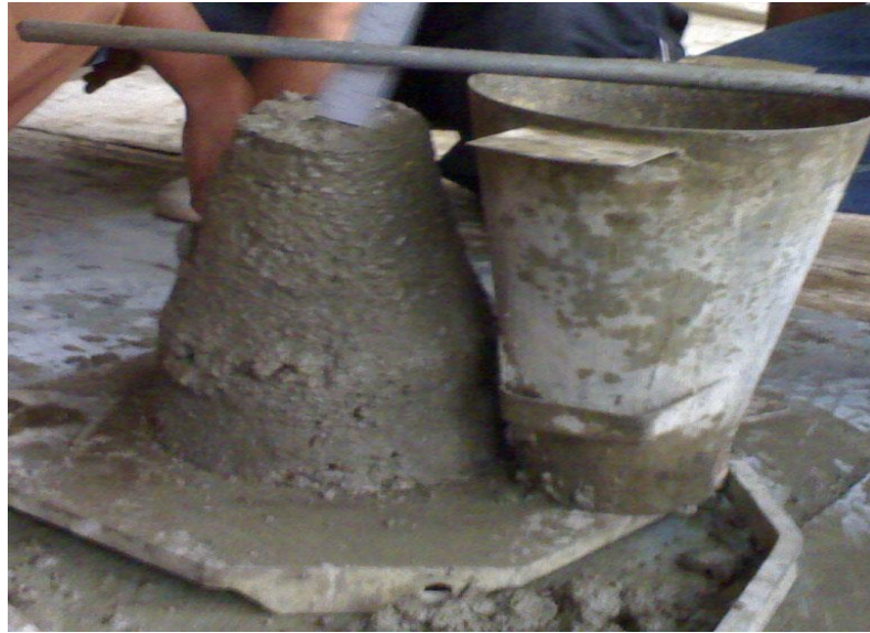
Gambar 15. MENGUKUR ANGKA SLUMP
