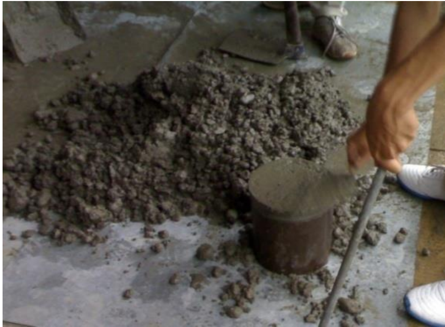
Gambar 6 : Uji Berat Isi Beton Segar
