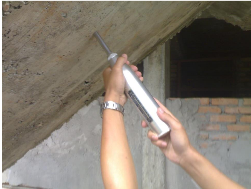
Gambar 24. Posisi Sudut Penggunaan Hammer Test \alpha + 45^\circ
