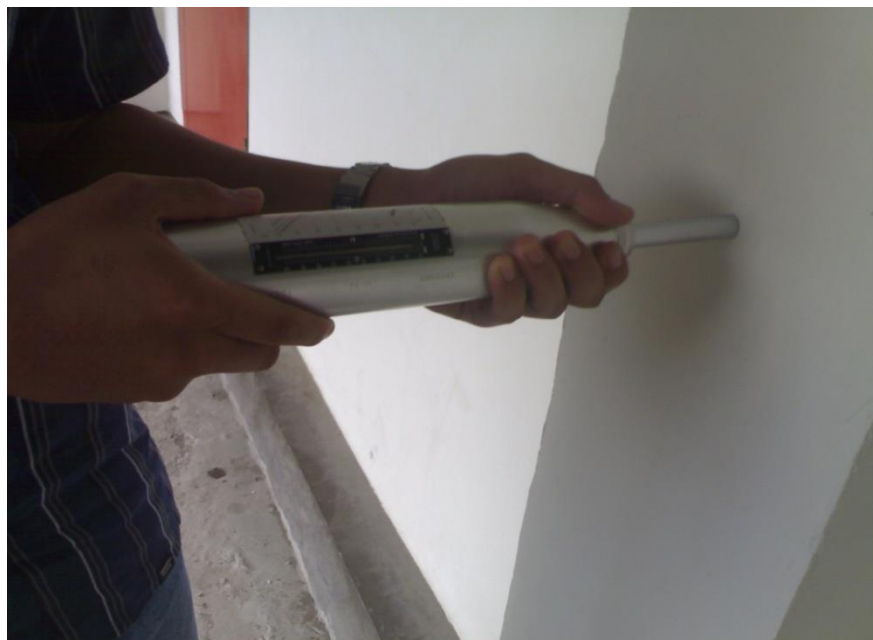
Gambar 23. Posisi Sudut Penggunaan Hammer Test \alpha - 0^\circ Referensi: Foto Dokumentasi Is
