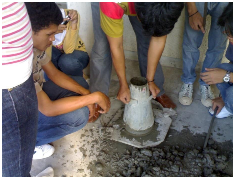
Gambar 14.Uji Keleccakan Beton dengan Slump
