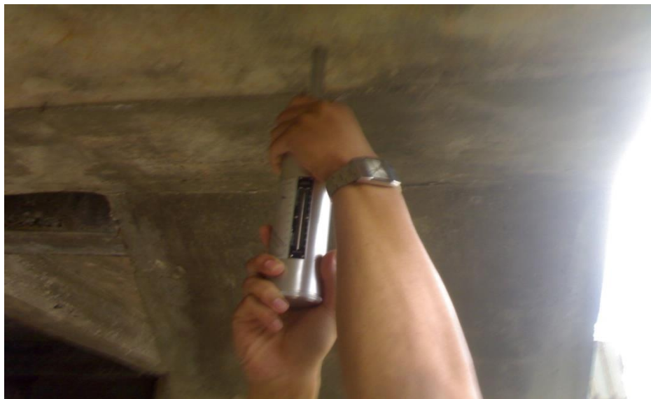
Gambar 21. Posisi Sudut Penggunaan Hammer Test \alpha + 90^\circ
