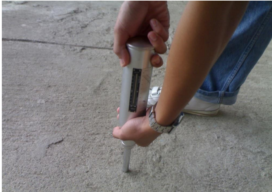
Gambar 22. Posisi Sudut Penggunaan Hammer Test \alpha - 90^\circ Referensi: Foto Dokumentasi Is
