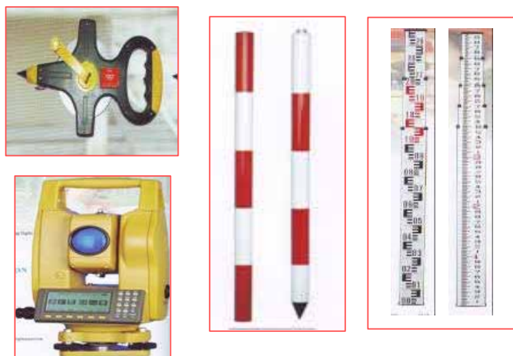
Gambar 3.12. Peralatan pematokan galian dan timbunan (meteran, theodolite, jalon dan rambu ukur)
