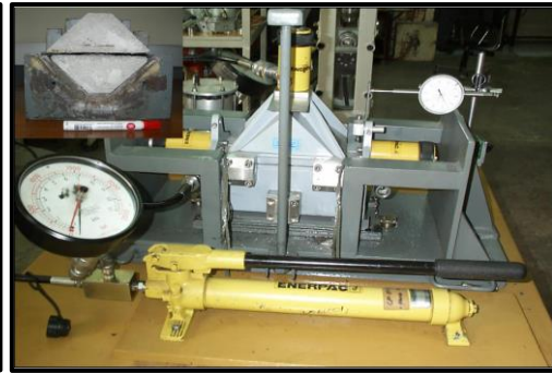
Gambar 101. Peralatan Uji Geser Langsung di Laboratorium
