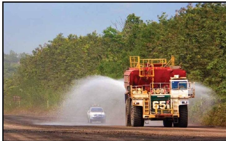
Gambar 30. Penyiraman Jalan Tambang dengan Menggunakan Water Truck (KPC, 2013)
