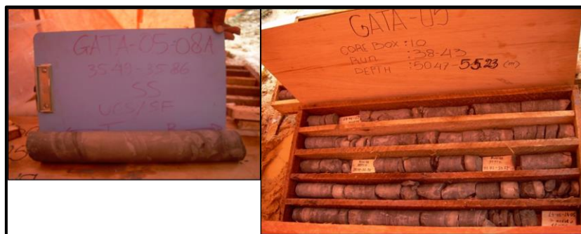
Gambar 84. Penyimpanan Contoh Geoteknik di Dalam Core Box
