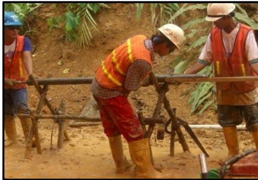
Gambar 83. Proses Pengambilan Contoh Geoteknik dari Core Barrel
