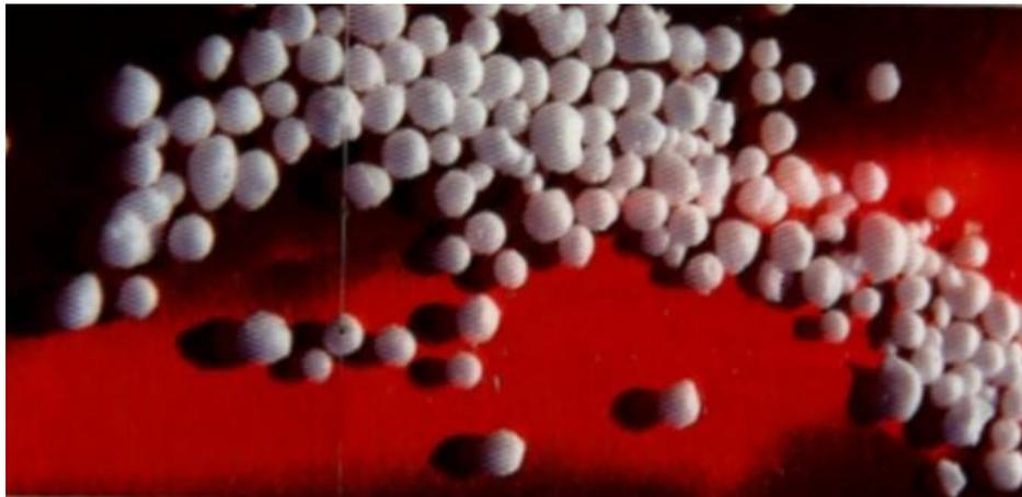
Gambar 6.5 Butiran ammonium nitrat berukuran sebenarnya 2 – 3 mm
