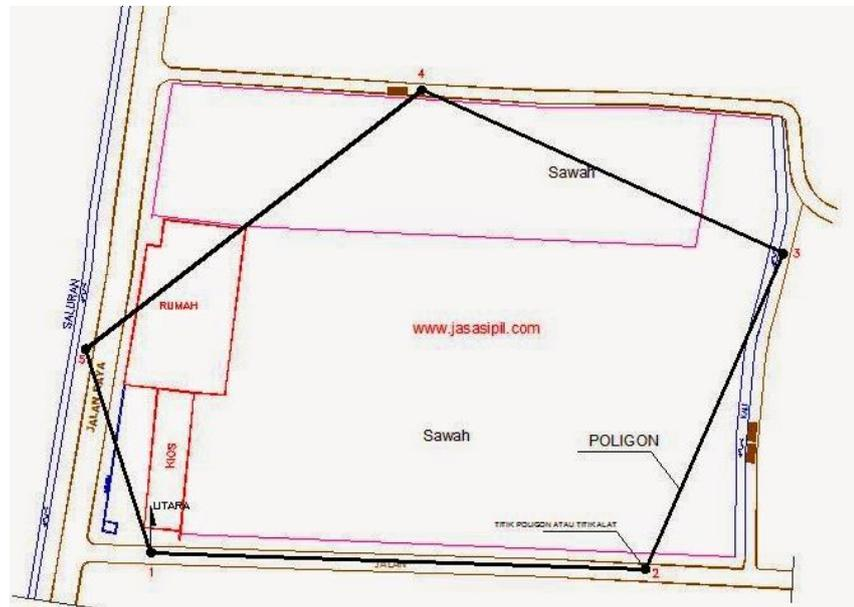
**Gambar 7.4. Cara mengukur luas tanah dengan theodolite**
