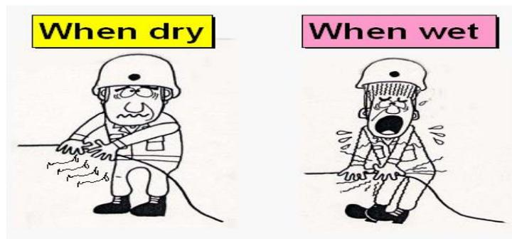
Gambar 3.3.17. Dalam pekerjaan yang menggunakan tenaga listrik, lingkungan harus kering
