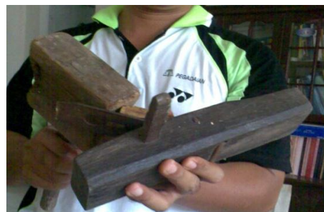
Gambar 5.13. Proses Penyetelan Mata Ketam
