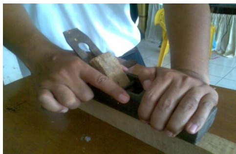
Gambar 5.14 Cara Menggunakan Ketam
