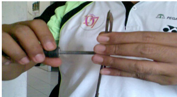
Gambar 5.11. Pengaturan Jarak Lapisan Mata Ketam Terhadap Sisi Tajam Mata Ketam
