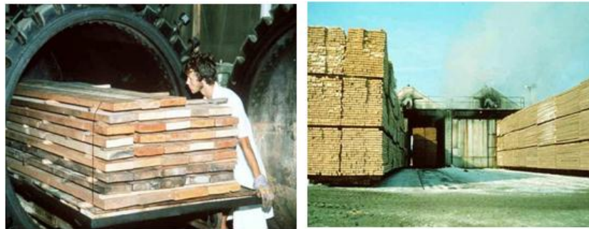
Gambar 3.12. Proses Pengeringan Kayu Buatan
