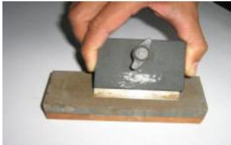
Gambar 5.74. Posisi mengasah mata pisau ketam
