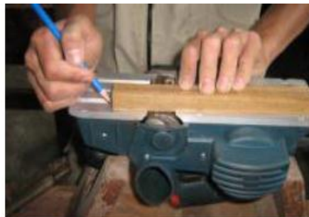
Gambar 5.73. Penyetelan ketinggian mata pisau ketam
