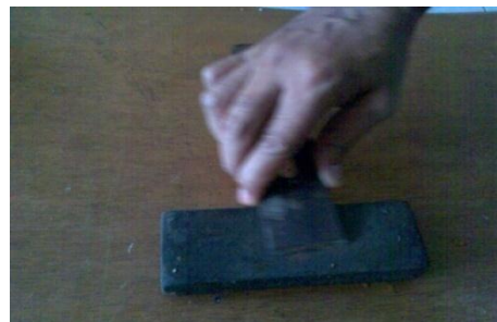
Gambar 5.12. Proses Pengasahan Mata Ketam
