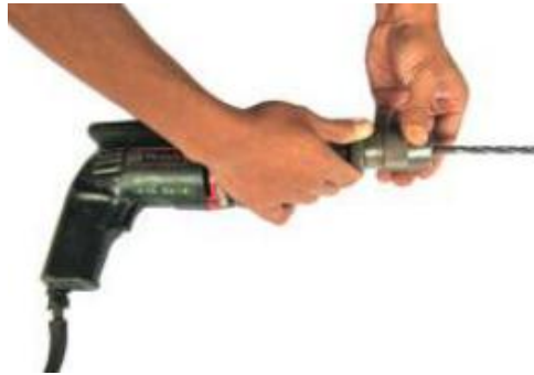
Gambar 5.26. Mesin Bor tanpa kunci cengkam
