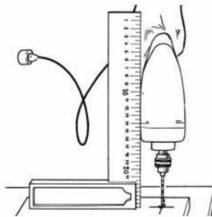
Gambar 5.62. Posisi Mengebor Vertikal
