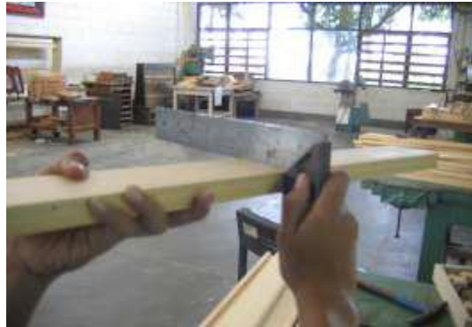
Gambar 5.3. Cara Menggunakan Siku-siku Untuk Memeriksa Kesikuan Benda Kerja
