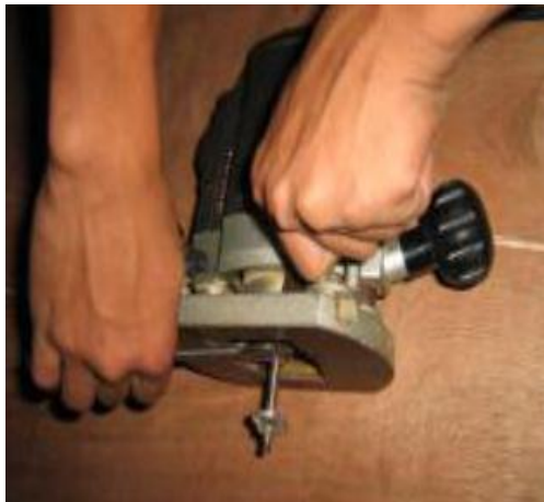
Gambar 5.86. Memasang pisau router
