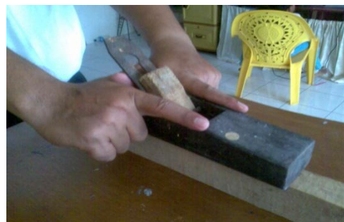
Gambar 5.14 Cara Menggunakan Ketam
