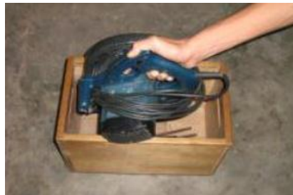
Gambar 5.93. Penyimpanan mesin gergaji tangan listrik
