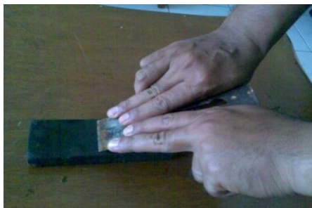
Gambar 5.12. Proses Pengasahan Mata Ketam
