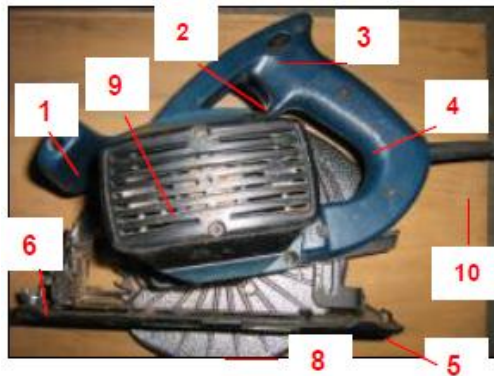
Gambar 5.90. Bagian-bagian Mesin Gergaji tangan Listrik
