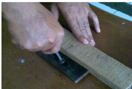
Gambar 5.13. Proses Penyetelan Mata Ketam
