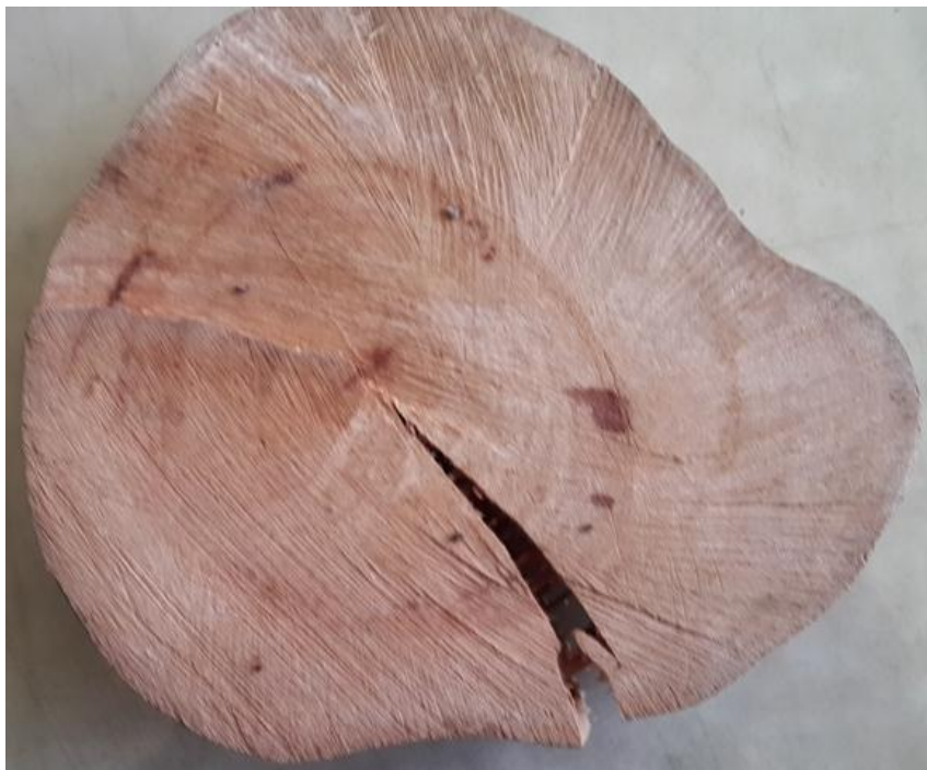
Gambar 38. Cacat Belah pada Log Kayu
