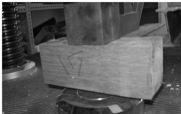
Gambar 18. Uji Tekan Kayu Kulim Tegaklurus Serat
