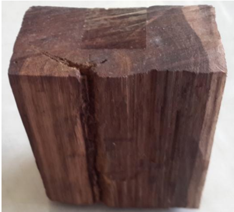
Gambar 39. Cacat pecah Pada Hati kayu
