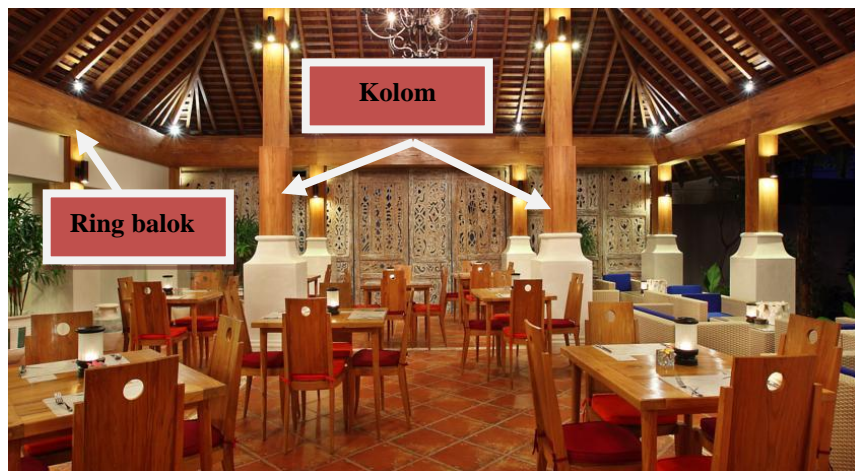
Gambar. 2 Kolom dan Balok dari Kayu Fungsi Struktural
