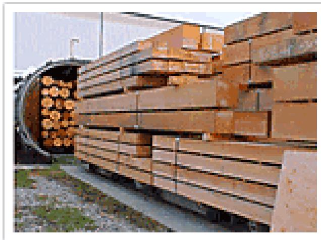
Gambar 33. Menyusun Kayu ke dalam Vacuum Kiln
