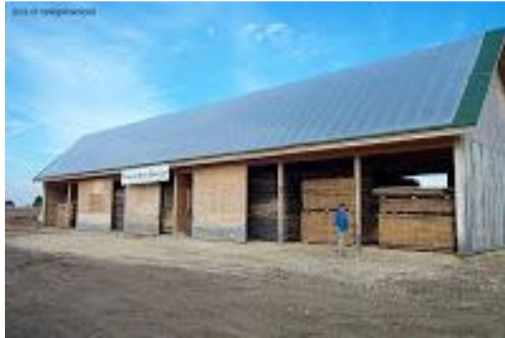
Gambar 36. Pengeringan Kayu dengan Solar Kiln Sumber : http://www.tentangkayu.com/2008/03/metodologi-pengeringan-kayu.html
