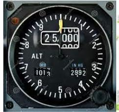
Gambar 17 Altimeter Pada Pesawat Udara
