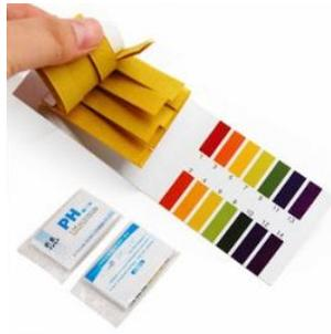
Gambar 26 pH Meter Strips
