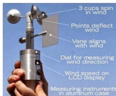
Gambar 19 Anemometer
