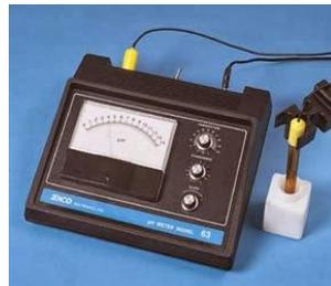
Gambar 27 pH Meter Analog
