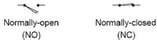
Gambar 2.11. Simbol dari Limit switch
