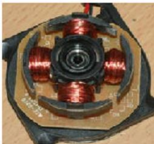
Gambar 2.40. Kutub pada stator motor DC brushless 2 fasa
