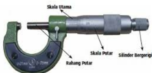
Gambar 31. Bagian-bagian micrometer sekrup
