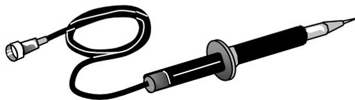
**Gambar. 3.2-3. Probe tegangan tinggi yang digunakan standar voltmeter. B dan K Dynascan**
