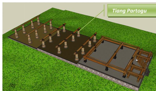
Gambar 2.8 (b) Denah posisi tiang
