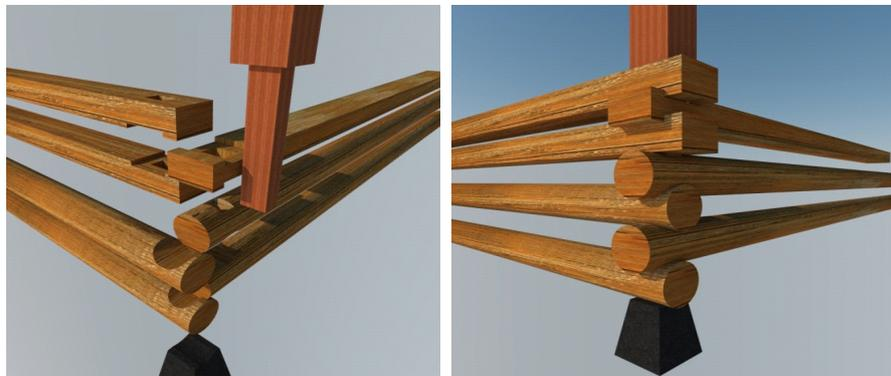
Gambar 2.10 Detail sambungan takikan, purus dan lubang pada koneksi antar balok galang, dan balok atas penyangga papan lantai
