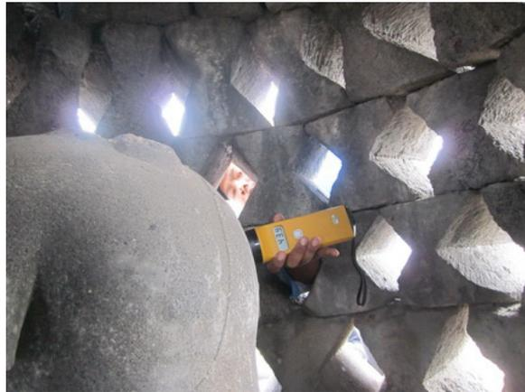
Foto 3.8 Pengukuran menggunakan magnetic susceptibility meter pada tubuh arca di dalam stupa teras
