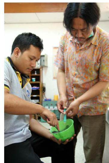
Foto 5.6 Proses pencampuran etil silikat
