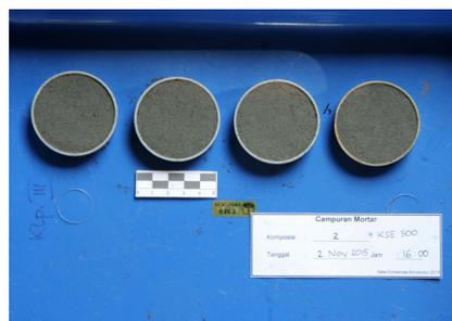
Foto 5.7 Benda uji mortar
