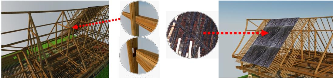
Gambar 2.21 Detail ikatan atap ijuk pada rangka atap
