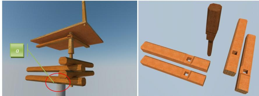
Gambar 2.11 Detail sambungan takikan, purus dan lubang pada koneksi antar balok *galang* pada bagian teras. (a) kondisi rawan terhadap geser
