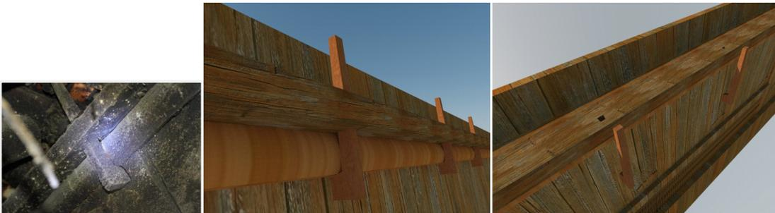
Gambar 2.19 Detail Sistem Sambungan menggunakan pasak pada bagian struktur dinding
