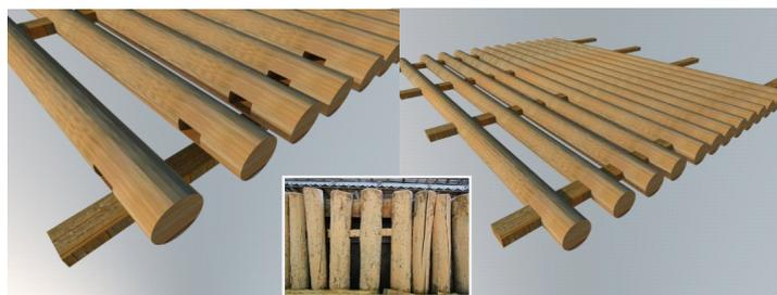
Gambar 2.17 Detail Sistem Sambungan Purus dan Lubang sebagai pengikat balok galang kecil
