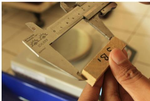
Foto 7.10. Pengukuran balok kayu dengan jangka sorong
