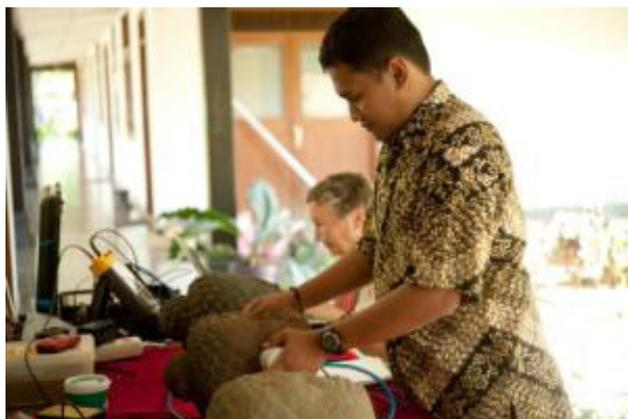
Foto 3.9 Pengukuran menggunakan ultrasonic pulse velocity tester (Dok: CICS, 2015).
