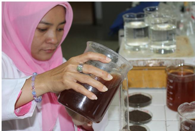
Foto 8.1 Pembuatan Larutan Induk Tanin Sintetik
