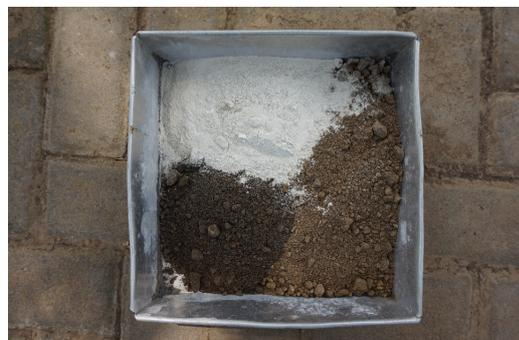
Foto 1.17 Komposisi campuran mortar percobaan
