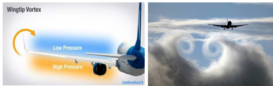
Gambar 21 : Perbedaan tekanan udara di sayap, dan turbulensi udara oleh sayap yang tanpa winglet Sumber: https://www.dream.co.id
