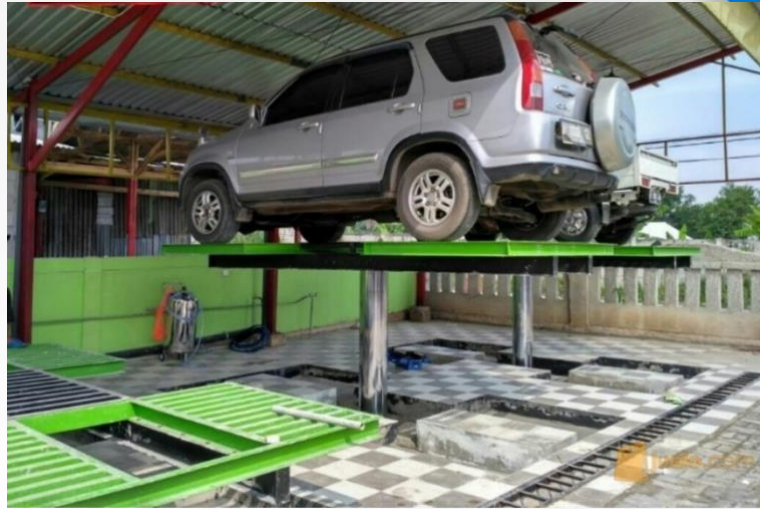
Gambar 2. SEQ Gambar_2. \* ARABIC 8 Pengangkat Mobil Hidrolik Sumber: https://storage.jualo.com
