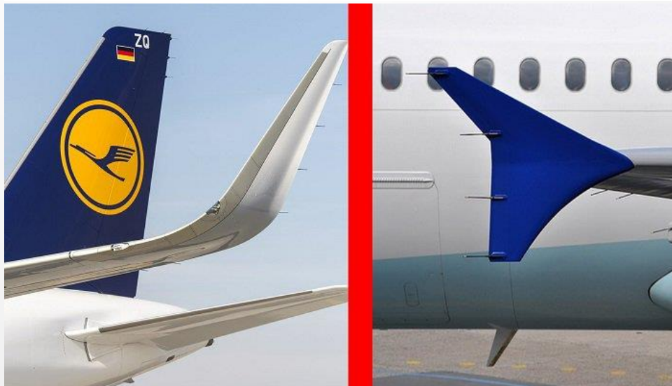
Gambar 2. SEQ Gambar_2. \* ARABIC 25 Jenis-jenis winglet di sayap pesawat Sumber: https://www.dream.co.id
