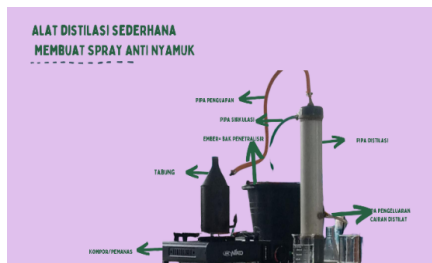
Gambar 1 siswa praktikum destilasi dan alat destilasi Sederhana
