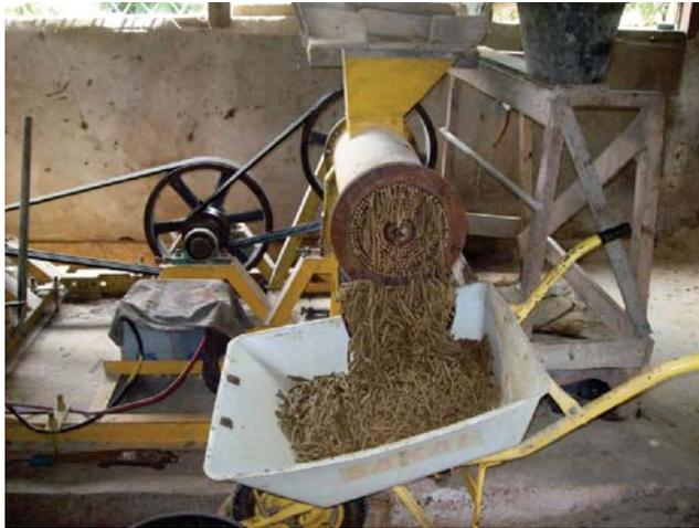
Gambar 21. Mesin pelet sederhana
