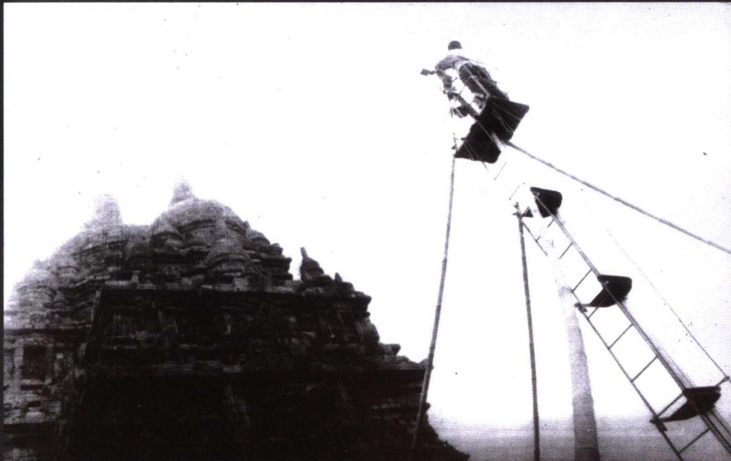
Pemotretan fotogrametri analog area atas pada candi sewu dengan perancah hidrolik
