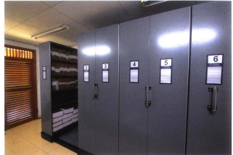
Ruang Penyimpanan Arsip Cellulose dengan Compact Rolling Shelving(CRS)
