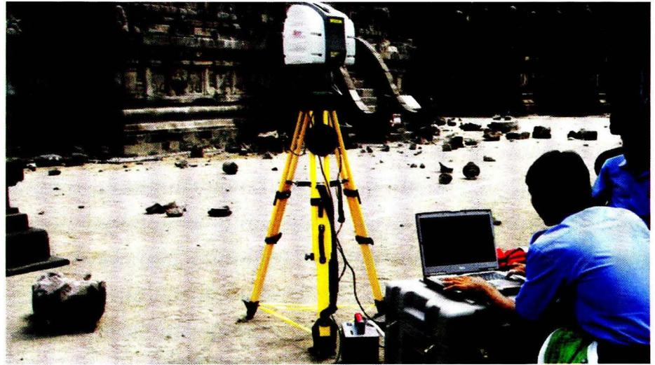
Pengukuran dengan teodolith dan pengukuran stabilitas menggunakan laser scanner
