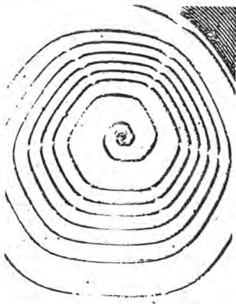
Gambar 14.79: Opname dari elektron mikroskop dari permukaan suatu kristal yang sedang mengalami pengembangan: dalam pengembangannya kristal mempunyai kesukaran untuk membentuk bidang baru dari bidang penghubung yang ada secara sempurna, karenanya terjadi dislokasi sekrup (pengembangan spiral) [dari Gahn, dikutip dari W. Finkelburg].
