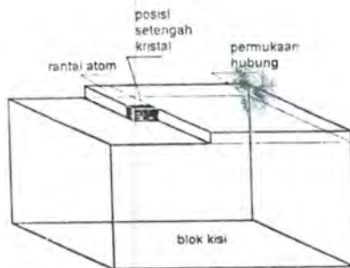
Gambar 14.26: Posisi setengah kristal sebagai "titik awal" suatu partikel yang merupakan awal rangkaian partikel berkembang lebih lanjut. Partikel ini meneguhkan setengah dari seluruh ikatan yang terdapat di dalam kristal.
