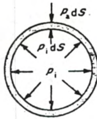
Gambar 3.22 Ketergantungan kelebihan tekanan pada gelembung bola sabun dari tegangan permukaan dan jari-jarinya
