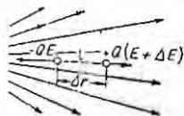
Gambar 6.24: Gaya yang bekerja pada sebuah dipol yang terdapat di dalam medan listrik inhomogen
