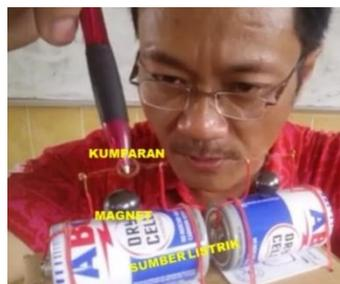
Dinamo Handmade merupakan peralatan praktik (magnet, kumparan, LED, dan voltmeter) yang terintegrasi menjadi satu. Jadi komponennya tidak terpisah seperti KIT IPA.
