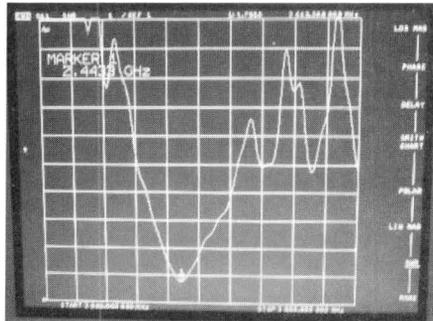
Gambar 4.4: Tampilan alat ukur network analyzer nampak bahwa  $S_{11}$  nya terendah pada 2,4433GHz
