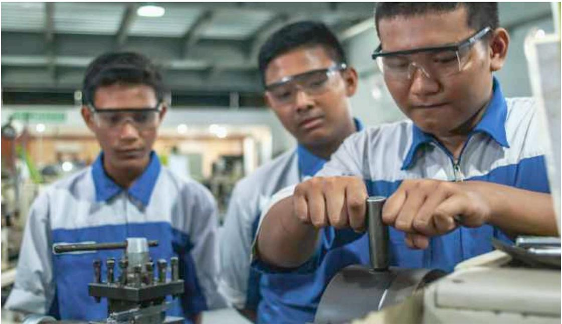
Perawatan mesin dimaksudkan agar kondisi mesin bubut selalu dalam kondisi terawat dan dalam keadaan siap pakai. Selain itu juga agar umur pakai (*life time*) mesin bubut dapat lebih lama. Perawatan ini sebaiknya dilakukan oleh operator yang menggunakan mesin bubut tersebut maupun teknisi yang memang bertanggungjawab terhadap kondisi mesin bubut tersebut. Perawatan ini dilakukan juga dalam rangka menjaga aspek keselamatan kerja dalam penggunaan mesin.
