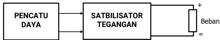
Gambar 36. Skema blok pencatu daya yang dilengkapi stabilisator tegangan
