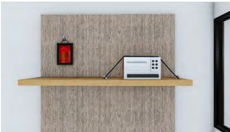
Gambar 7. Komponen non-struktural harus diberi pengaku
