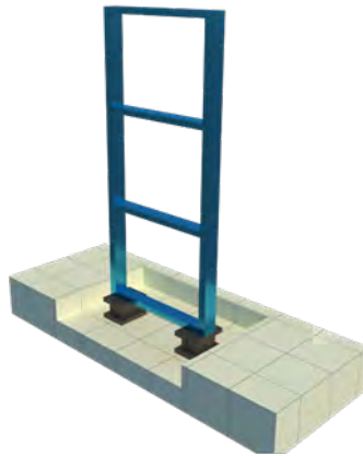
Gambar 8. Ilustrasi struktur yang diberikan isolation bearing
