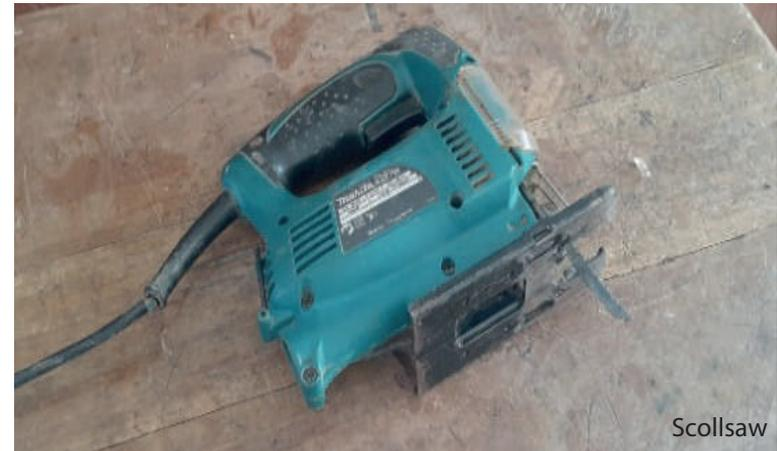
Gambar 9. Scoll saw digunakan untuk memotong kayu, terutama untuk membentuk potongan yang berlekuk-lekuk dan bentuknya kecil
