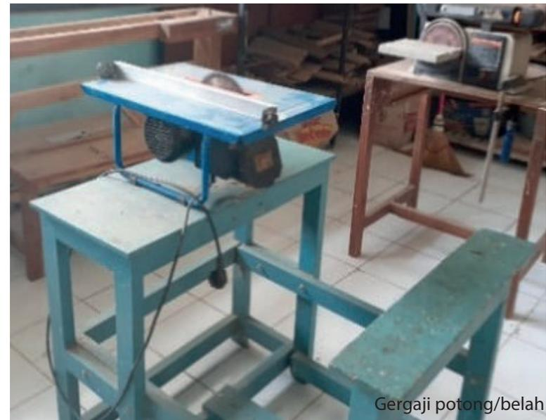
Gambar 10. Gergaji potong/belah berfungsi untuk memotong kayu
