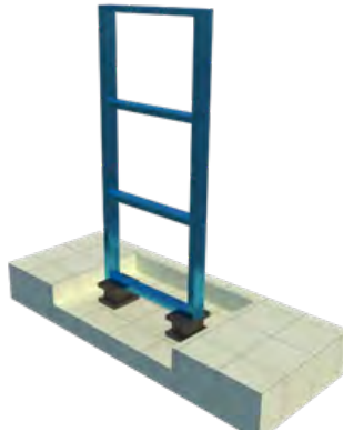
Gambar 8. Ilustrasi struktur yang diberikan isolation bearing
