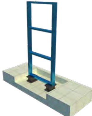
Gambar 8. Ilustrasi struktur yang diberikan isolation bearing
