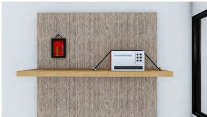
Gambar 7. Komponen non-struktur harus diberi pengaku
