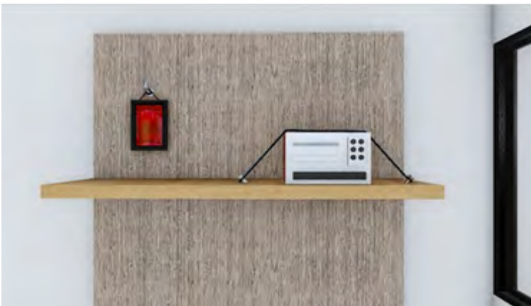
Gambar 7. Komponen non-struktur harus diberi pengaku
