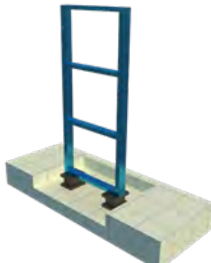
Gambar 8. Ilustrasi struktur yang diberikan isolation bearing
