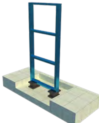
Gambar 8. Ilustrasi struktur yang diberikan isolation bearing
