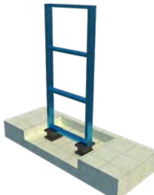
Gambar 8. Ilustrasi struktur yang diberikan isolation bearing
