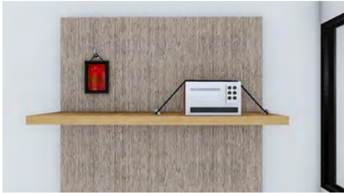
Gambar 7. Komponen non-struktur harus diberi pengaku
