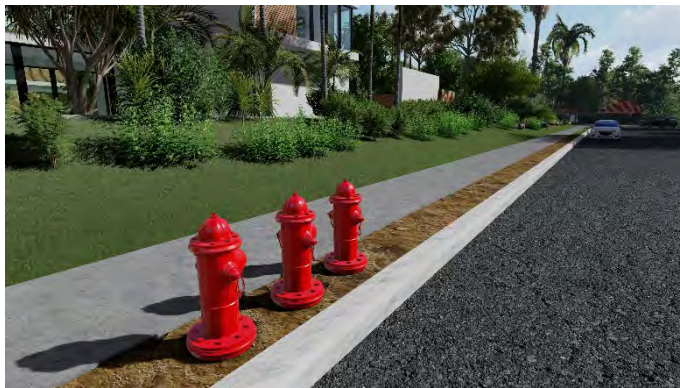
Gambar 9. Ilustrasi penempatan pipa hydrant di jalan
