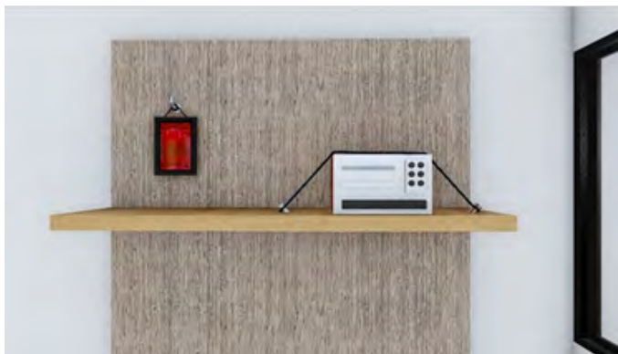
Gambar 7. Komponen non-struktur harus diberi pengaku
