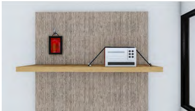
Gambar 7. Komponen non-struktur harus diberi pengaku
