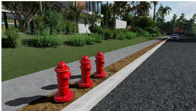
Gambar 9. Ilustrasi penempatan sistem hydrant lingkungan
